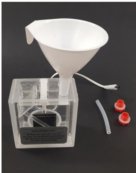
*Coloque con cuidado el embudo sobre la salida del generador.*
