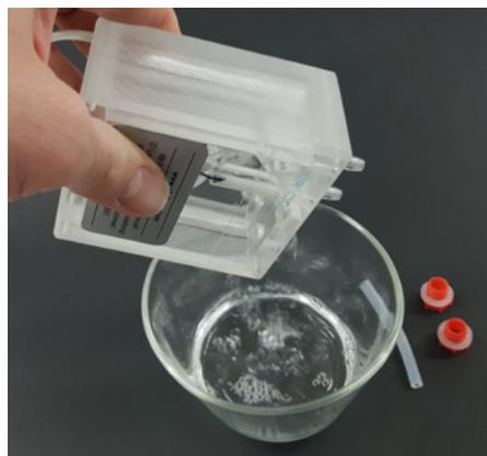
*Bote el agua del generador a cualquier recipiente. Entonces vierta el agua del recipiente al desagüe.*
