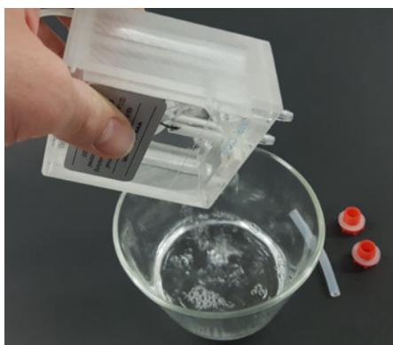
**Lassen Sie das Wasser im Generator in ein Gefäß ab. Danach gießen Sie das Wasser aus dem Gefäß in den Abfluss.**
