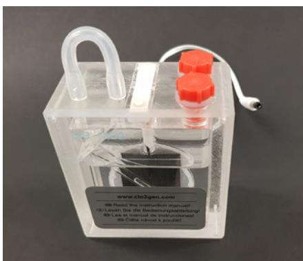
oder den Hersteller. Stellen Sie beim Starten des Generators sicher, dass alle Verbindungen gemäß den Anweisungen angeschlossen sind und dass der Generator am Auslass (Ausgang mit der Bezeichnung ClO<sub>2</sub> – Schlauchauslass in das Wassergefäß) Blasen abblässt.
