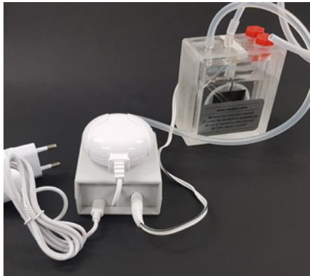
Verbinden Sie den Generator und die Stromversorgung mit dem elektronischen Teil.
