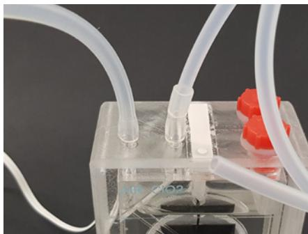
Conecte el flexible de silicona del compresor con „AIR“ y el flexible de plástico duro con „ClO<sub>2</sub>“
