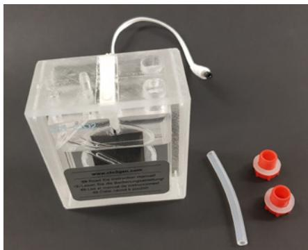
**Entfernen Sie die Verbindung der AIR – und ClO<sub>2</sub>-Ausgänge. Beide Einlassstopfen vorsichtig herausdrehen.**
