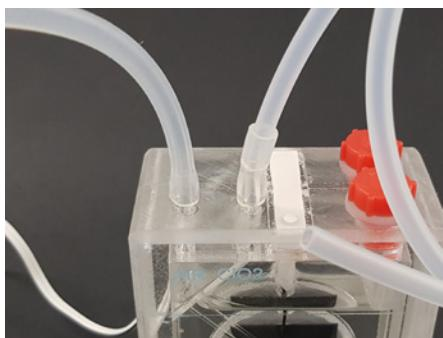
Silikonschlauch aus dem Kompressor an „AIR“, Hartplastikschlauch an „ClO<sub>2</sub>“ anschließen.
